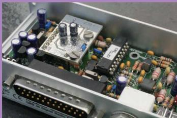
Die DiRaBox DRB 30 ist ein leistungsfähiger Doppelüberlagerungsempfänger mit einem digitalen Synthesizer (DDS) als Abstimmoszillator. Das DDS-Prinzip vereint kleinste Abstimmschrittweiten mit geringstem Phasenrauschen.
